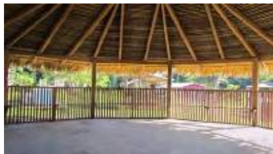
Foto 32: Detalhe da casa de reunião da Comunidade São Francisco, construída com madeira de jarana ( Lecythis retusa ) e cobertura com troncos de amarelão ( Apuleia leiocarpa ) e palha de babaçu ( Attalea speciosa ) (28.jun.19).
